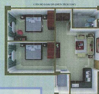
MẶT BẰNG CĂN HỘ 51M 2
