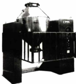
Hình 7.9. Các loại thùng trộn a) Thùng trộn hai đầu hình côn; b) Thùng trộn chữ V.
