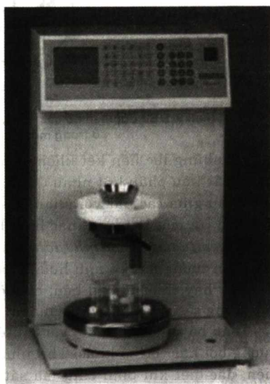
Hình 9.3. Máy đo tốc độ chảy của hạt hiệu ERWEKA
