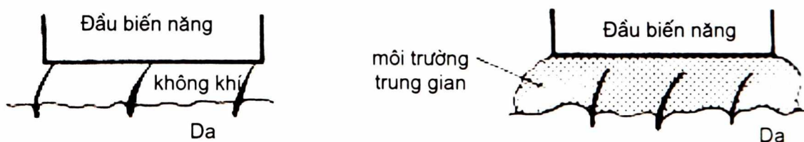
Hình 4.6. Sử dụng môi trường trung gian giữa đầu biến năng và mặt da
