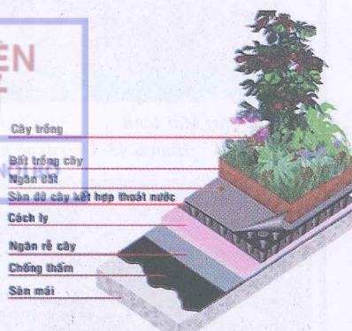
Hình B.41. Thứ tự các lớp cho cấu tạo kiến trúc mái xanh chuyên sâu kết hợp truyền thống.
